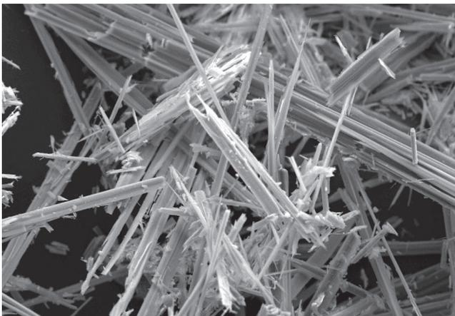
Asbestfasern unter dem Rasterelektronenmikroskop
